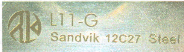
Зображення 5. Збільшене зображення маркувальних позначень на клинку.
